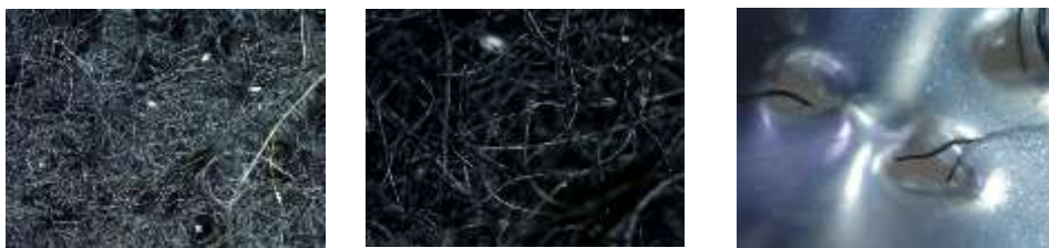
Рисунок 2.4 -Дублированный нетканый иглопробивной материал ВИ-350 +МП (черный)
