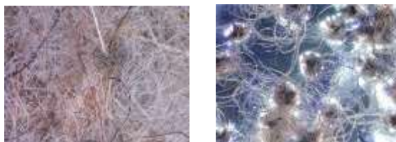
Рисунок 2.5 - Дублированный нетканый иглопробивной материал ВИ (ЧШ) 350+МП
