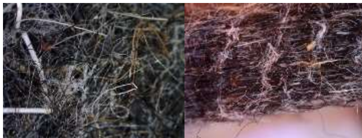
Рисунок 2.8 - Полотно термоскрепленное ПТ- 800/20 (ЧШ)
