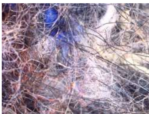
Рисунок 2.1 - Нетканый иглопробивной материал ВИ (РВЛ) 500/10
