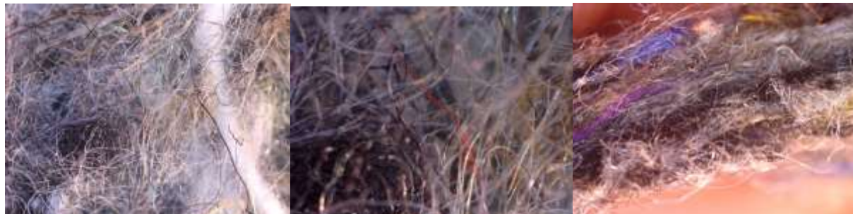
Рисунок 2.2 - Нетканый иглопробивной материал ВИ (РВЛ) 700/10
