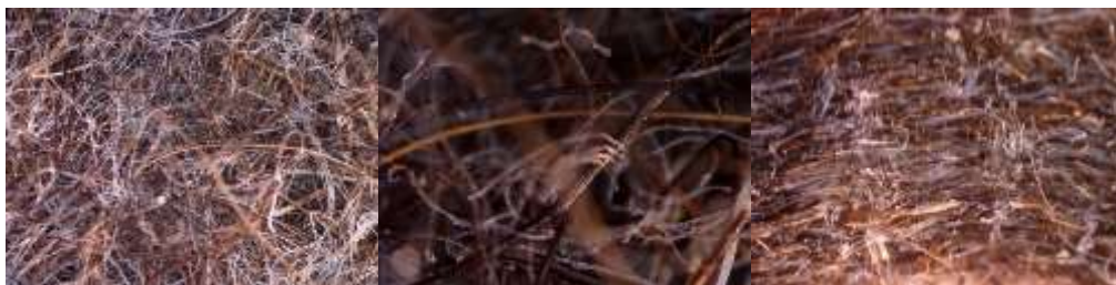
Рисунок 2.9 - Полотно термоскрепленное ПТ- 1000/20 (ЧШ)
